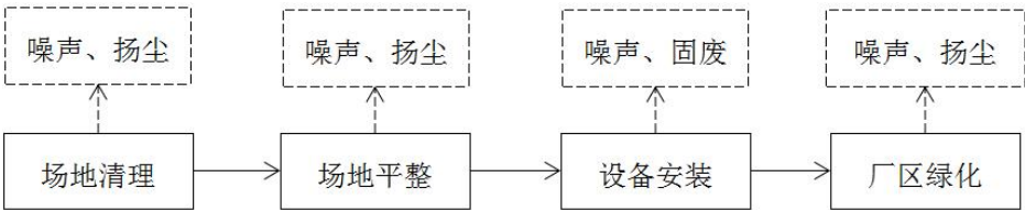
图 2 项目施工期工艺流程及产排污节点图
