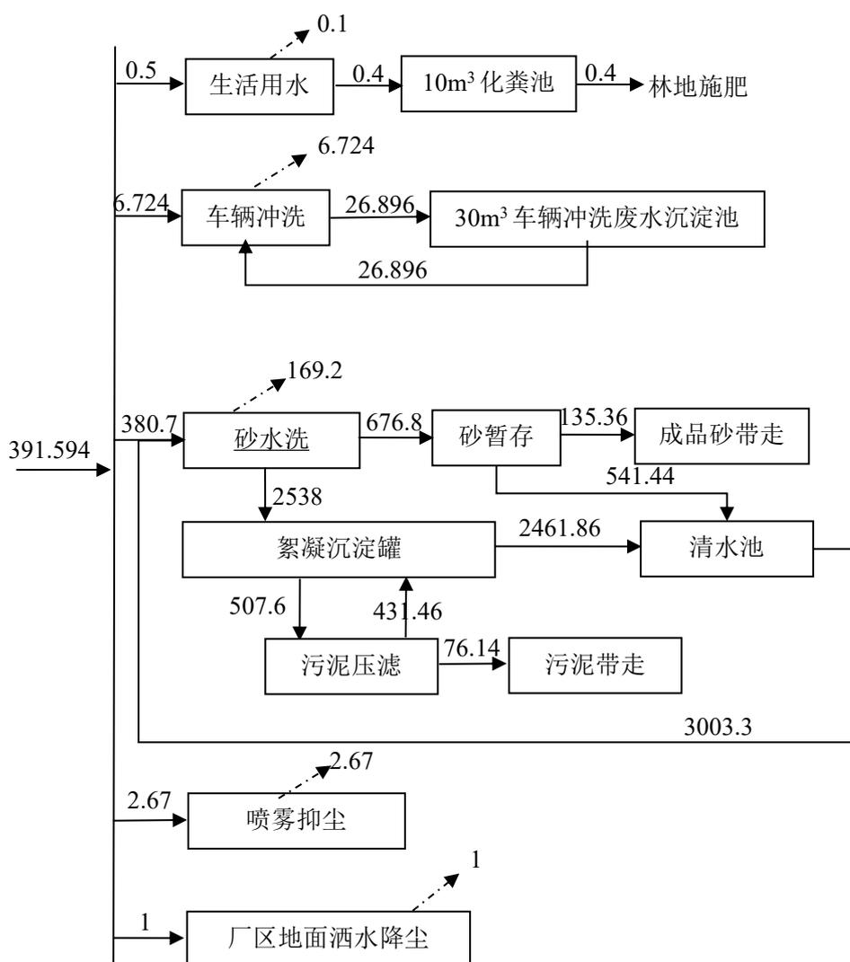
图 2 项目水平衡图 单位 m³/d
